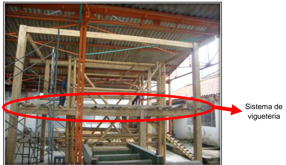
Figura 31: Prototipo Con Viguetería en Guadua Rolliza
