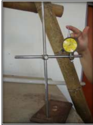
Figura 32: Comparador de carátula utilizado en prueba de carga
